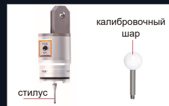
Комплект щупов (опц.), включает стилусы Ø1 мм, Ø2 мм, Ø3 мм, калибровочный шар Ø25 мм; точность 10 мкм
